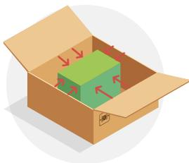
Debe existir como mínimo de 3 a 5 cm entre el material y las paredes de la caja (fondo, tapa y costados).
